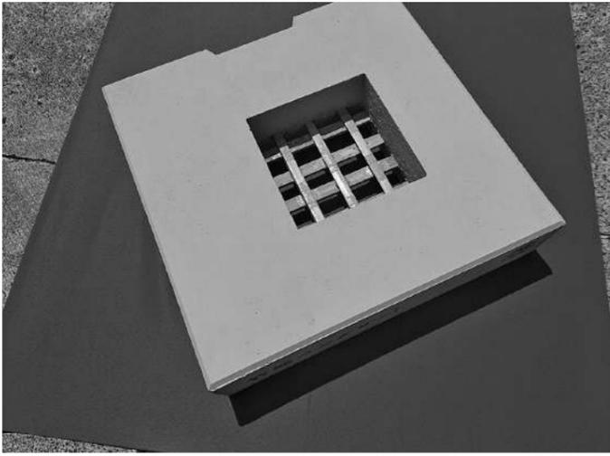
鉄筋の代わりに骨組みに竹を用いた落蓋型側溝用ふた
