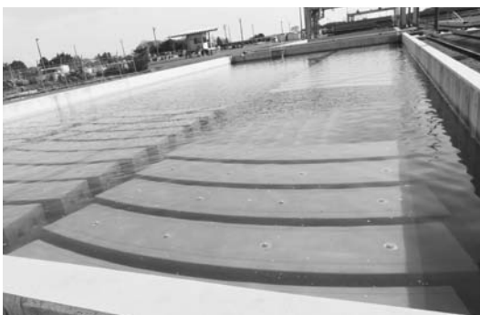
脱型したあとと水槽で1週間養生する
