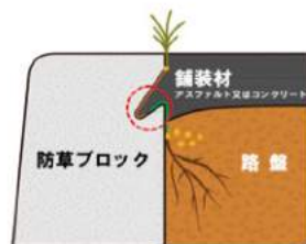
図-1 目地部断面切り欠け
